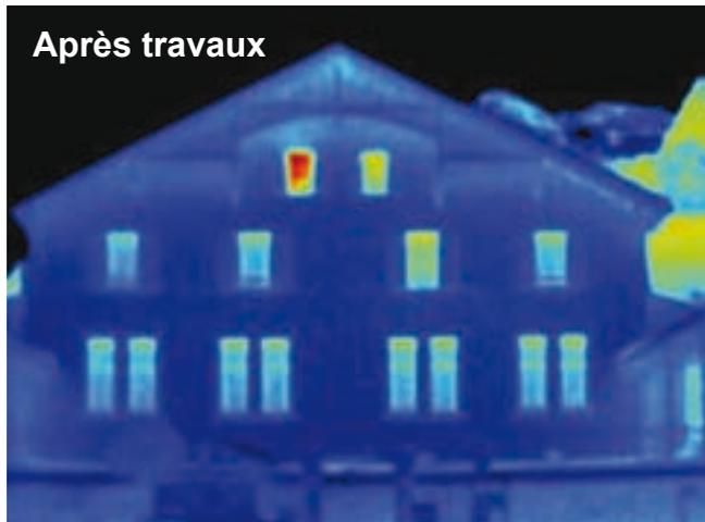
Photo thermique de l'école de Servoz. Ces deux photos ont été prises en hiver alors que le bâtiment est chauffé. Les couleurs jaune et surtout rouge correspondent à des parois chaudes, le couleurs bleu à du froid. Dans l'image de droite, la zone rouge est due à une fenêtre... ouverte !
